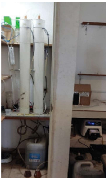
Figura 1. Biofiltros anaerobios en una cabina con control de temperatura.
