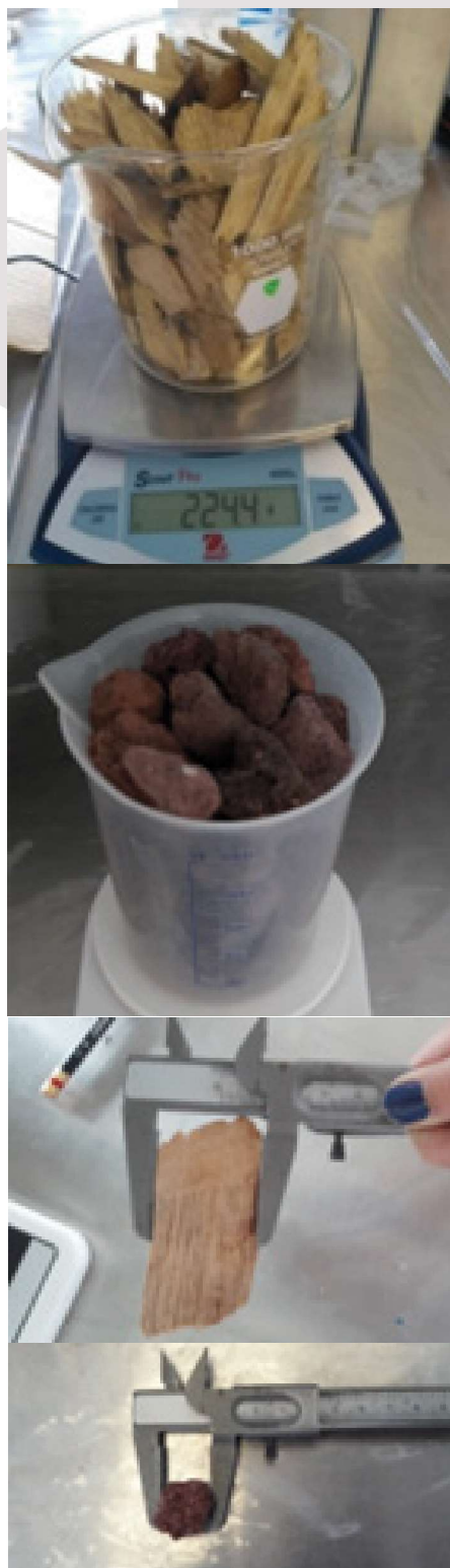
Figura 2. Determinación de densidad aparente y área de contacto del material filtrante.
