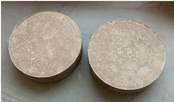
Fig. 2. Probetas cilíndricas de BTC.
