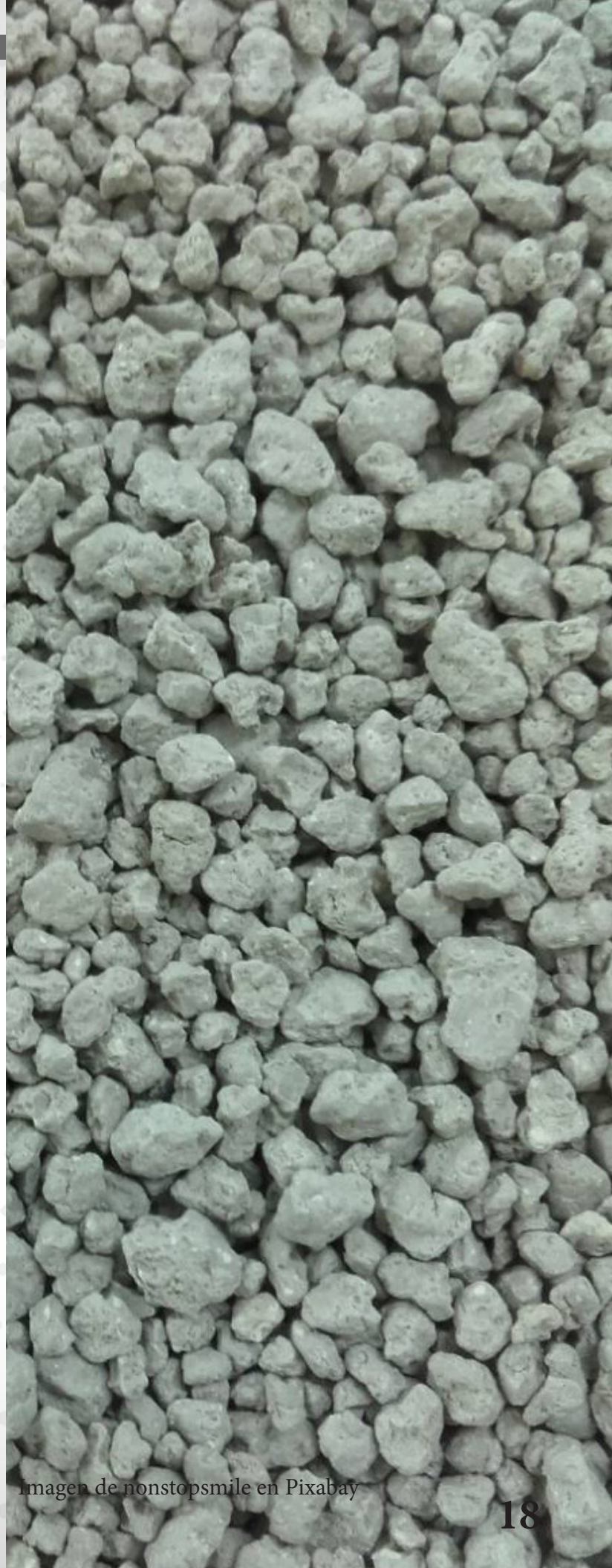
Fig. 3. Pellets de bentonita-mucílago de nopal-cemento.
