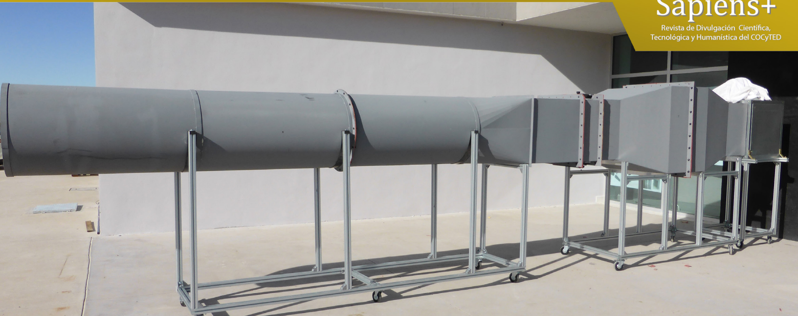
Banco de pruebas de intercambiadores de calor compactos Centro de Investigación en Materiales Avanzados, S.C. Subsede Durango
