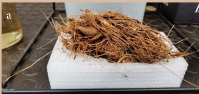
Figura 2. Material utilizado para la eliminación de flúor y arsénico a) Bagazo de A. durangensis y b) Zeolita natural.
