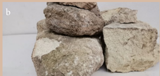
Figura 2. Material utilizado para la eliminación de flúor y arsénico a) Bagazo de A. durangensis y b) Zeolita natural.
