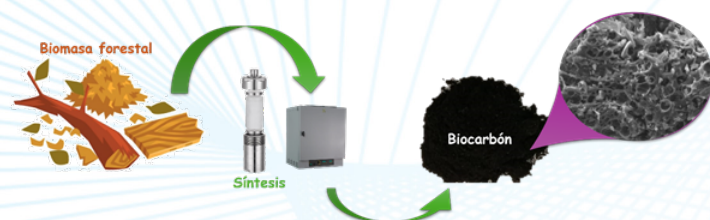
Figura 2. Transformación de biomasa forestal en biocarbón bajo condiciones controladas.
